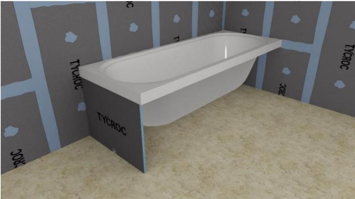
Bei Bedarf schneiden Sie die Verkleidung in die richtige Größe. Stellen Sie sicher, dass es unter dem Wannenrand außer der Tycroc-Badewannenverkleidung Platz auch für später verlegte keramische Fliesen (oder Naturstein) bleibt. Tragen Sie Tycroc Premium FIX Kleb- und Dichtstoff auf den oberen Rand der Badewannenverkleidung, sodass es auf dem ganzen Rand einen ununterbrochenen Streifen des Kleb- und Dichtstoffs gibt.
