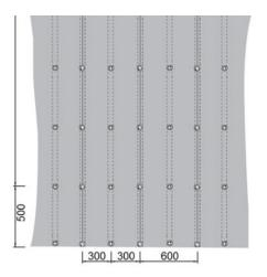
А) / В) Уложить строительную плиту на пол и крепко прижать к поверхности, зафиксировав ее соответствующими шурупами для дерева и крепежными шайбами Тусгос. Используемые шурупы должны проникать в основание как минимум на 20 мм. Крепить шурупы с шагом 500 мм. Перед установкой следующей плиты нанести на край предыдущей плиты клей-герметик Тусгос Premium FIX, чтобы склеить строительные плиты между собой.
