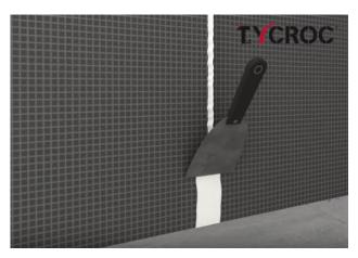
Используя шпатель, изолировать клеем-герметиком промежутки между строительными плитами, углы и другие проходы, покрыв им также крепежные шайбы. В душевом углу и других углах стена / стена или стена / пол, входящих в непосредственный контакт с водой, дополнительно использовать изоляционную ленту и гидроизоляционную мастику. Для изоляции торцов труб использовать клейгерметик Тусгос Premium FIX или, если проходы слишком велики, подходящую изоляционную манжету и гидроизоляционную мастику.
