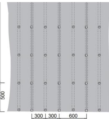
А) / В) Уложить строительную плиту на пол и крепко прижать к поверхности, зафиксировав ее соответствующими шурупами для дерева и крепежными шайбами Тускос. Используемые шурупы должны проникать в основание как минимум на 20 мм. Крепить шурупы с шагом 500 мм. Перед установкой следующей плиты нанести на край предыдущей плиты клей-герметик Тускос Premium Fix, чтобы склеить строительные плиты между собой.
