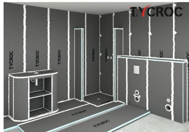
4.3 Уложить строительную плиту Тусгос TWP на пол и крепко прижать ее к поверхности либо весом собственного тела, либо с помощью дополнительного груза (например, мешком с клеевым раствором и т.п.). Перед установкой следующей плиты нанести на край предыдущей плиты клей-герметик Tycroc Premium Fix, чтобы склеить строительные плиты между собой.
