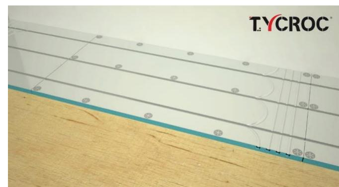
Turpmāk, veidojot peldošo grīdas virsmu, Tycroc UHP plāksnes var piestiprināt pie koka grīdas arī ar kokam paredzētām skrūvēm un Tycroc stiprinājuma paplāksnēm. Maksimālais attālums starp stiprinājuma vietām nedrīkst pārsniegt 300 mm. Uzmanību! Tycroc UHP plāksņu uzstādīšana ar līmi nodrošina līdzenei un stabilāku pamatvirsmu zem grīdas virsmas seguma materiāla.
