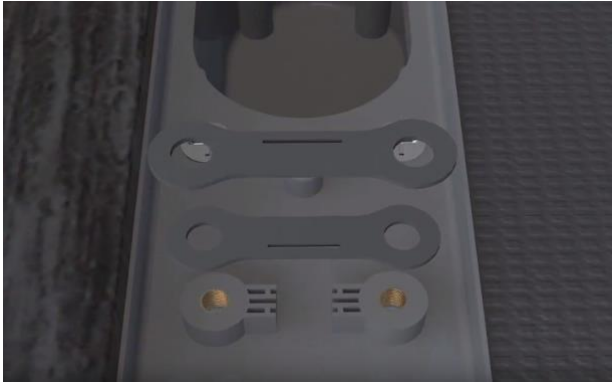
11. Ruostumattomasta teräksestä lattiakaivon kourun (nro 8) korkeuden säätämiseksi voit käyttää tarvittaessa välikiloja (nro 5) laittamalla kiilat päällekkäin kerroksittain kunnes kourun reuna on samalla korkeudella kuin lattialaatta.
