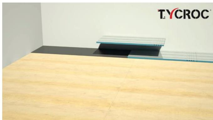
Уложить плиты на смесь / клей и прижать, чтобы плита приклеилась к основанию. Проверить, чтобы плиты на полу были уложены горизонтально (при выравнивании хорошо применить молоток и деревянную опорную доску или брусок – постукивая, уложить плиту в горизонтальное положение).
