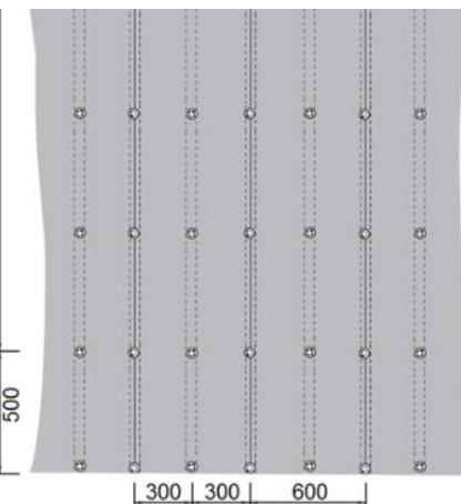
A) / B) Dėkite statybinę plokštę ant grindų bei tvirtai prispauskite ją prie paviršiaus, pritvirtinkite statybinę plokštę atitinkamais medusraigčiais ir Tycroc tvirtinimo poveržlėmis. Naudokite varžtus, įsukamus į pagrindą bent 20 mm. Varžtus sukite kas 500mm. Prieš kitos plokštės klojimą ankstesnės plokštės kraštą sutepkite Tycroc Premium Fix hermetiniais klijais, kad statybinės plokštės tarpusavyje susiklijuotų.
