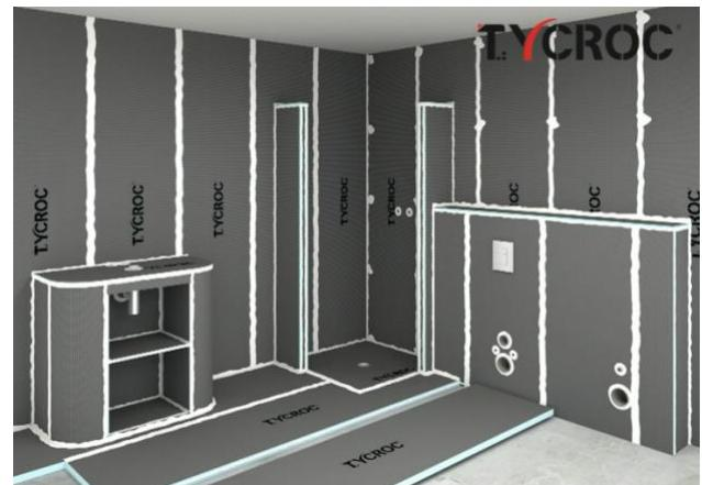
4.3 Dėkite Tycroc TWP statybinę plokštę ant grindų bei tvirtai prispauskite prie paviršiaus savo kūno svoriu arba naudojant papildomą svorį (pvz., mišinio maišą ar pan.). Prieš kitos plokštės klojimą ankstesnės plokštės kraštą sutepkite Tycroc Premium Fix hermetiniais klijais, kad statybinės plokštės tarpusavyje susiklijuotų.
