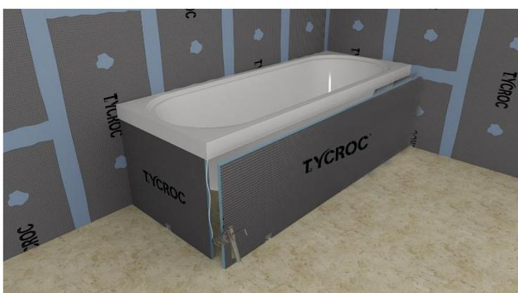
При необходимости следует повторить предыдущие действия с другой стороны ванны. Зафиксировать и изолировать панели друг от друга, используя для этого клей-герметик Тусрос Premium Fix.
